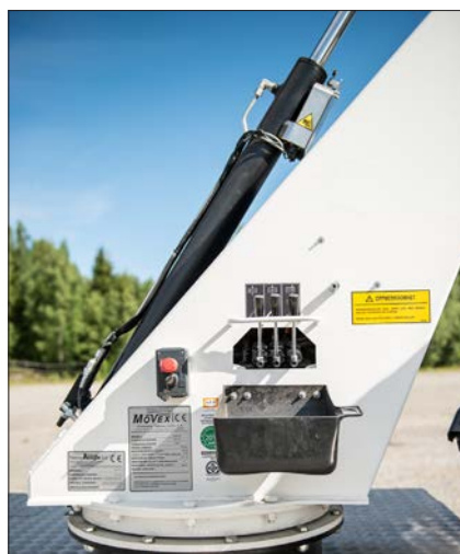
Bakkekontrollpanel på siden av bommen
